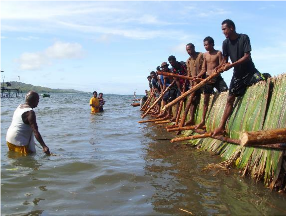
圖片 11. 在 baditauna 的指揮下，男孩們一起打 lagatoi 的側邊打緊
